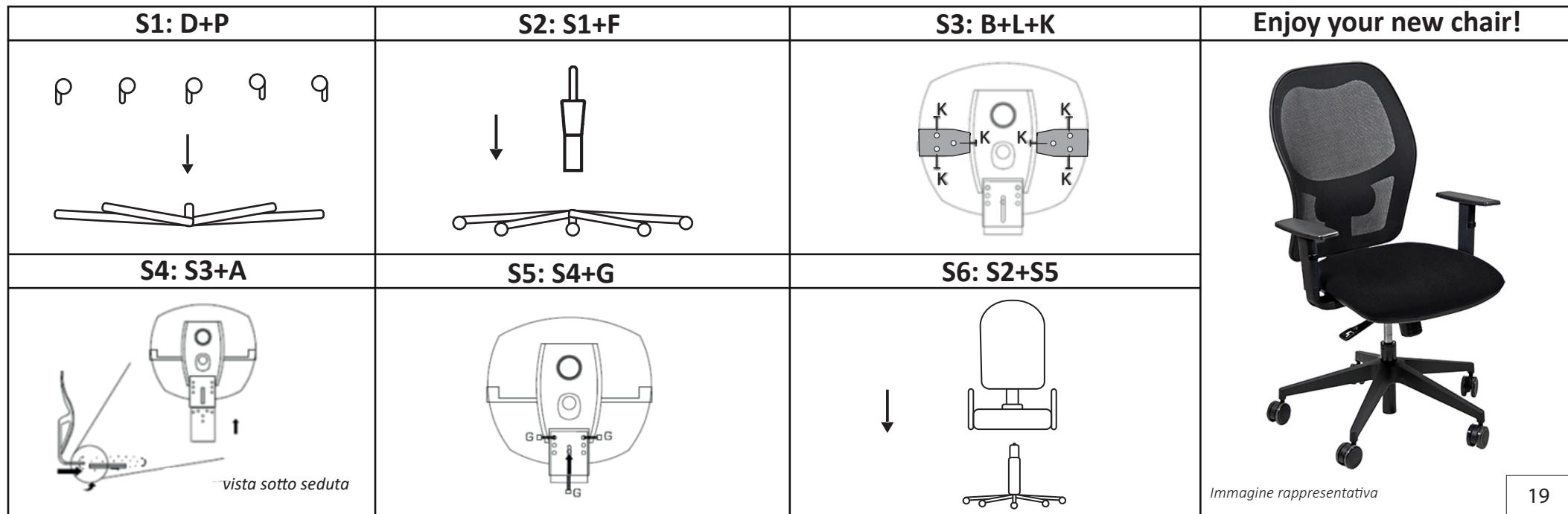
**MANUTENZIONE MECCANISMI:** non necessita di manutenzione. Controllare periodicamente il serraggio delle viti e assicurarsi che tutte le viti e tutti i bulloni siano serrati.
